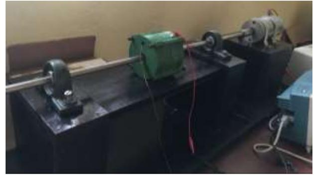
**Figura 8** Implementación de estructura mecánica del banco de pruebas
