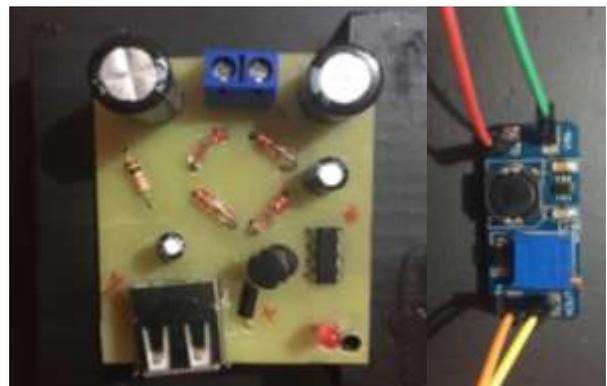
**Figura 15** Circuito rectificador, convertidor Buck en placa fenólica y módulo convertidor Boost
