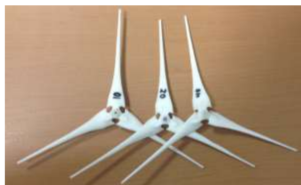
Figura 8 Sistema de tres hélices y modelos modificados del aspa impresos en 3D Fuente: Elaboración Propia
