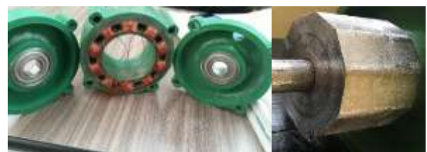
Figura 10 Generador de imanes permanentes de 10 polos
