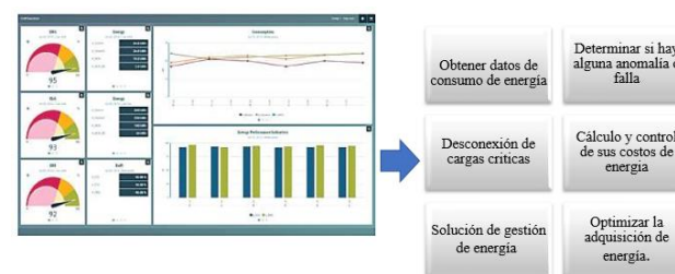
Figura 8 Software de consumo de energía Energy Manager y Aplicaciones Fuente: https://new.siemens.com
