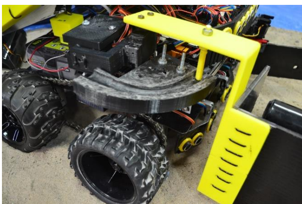
Figura 9 Sistema de recolección de latas WIGO Robot de playa 2015
