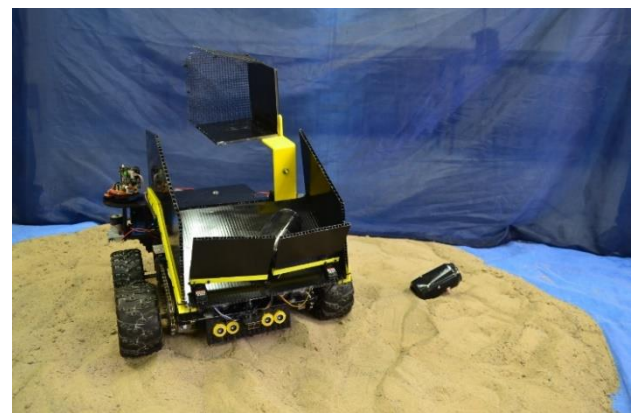
Figura 11 Movimiento elevador en sistema de recolección
