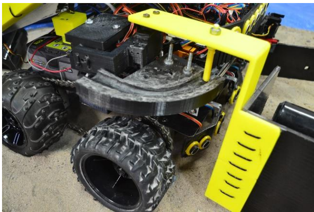
Figura 12 Implementación de carril guía para pala recolectora
