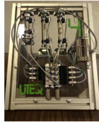
Figura 1 Estación electroneumática Fuente: Elaboración Propia
