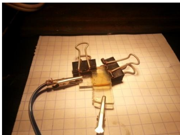
Figura 1 Ensamble y prueba energética de la DSSC
