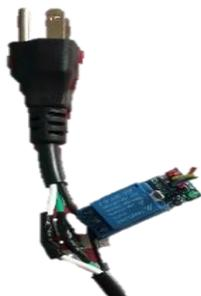
Figura 7 Relé (interruptor eléctrico)
