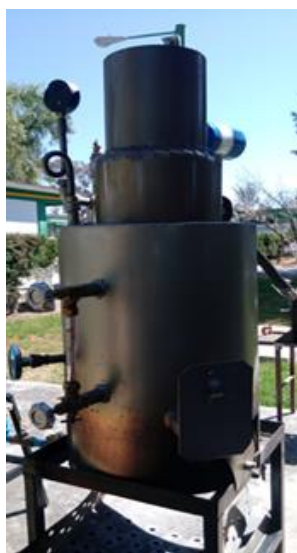
Figura 5 Sistema para la microgeneración de vapor
