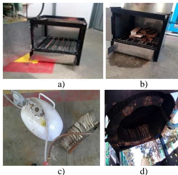
Figura 7 Componentes del hogar de combustión, donde: a) hogar de combustión para la biomasa, b) integración del hogar de combustión y cilindro a presión c) quemador de GLP, d) integración del quemador al cilindro
