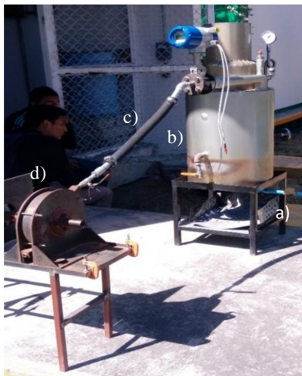
Figura 2 Componentes del sistema de microgeneración, donde: a) hogar de combustión, b) recipiente cilíndrico a presión instrumentado, c) línea de vapor con medidor de flujo y d) micro turbina de adhesión.
