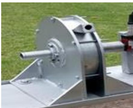
**Figura 3** Micro-turbina de adhesión
