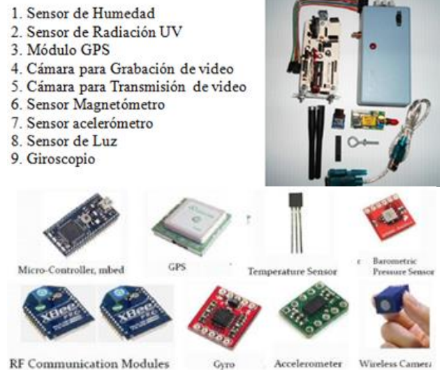
Figura 6 Sensores adicionales para el CanSat de telemetría
