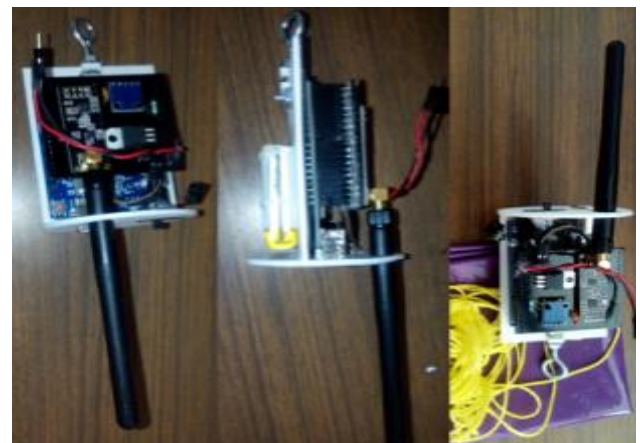
Figura 3 CanSat de telemetría
