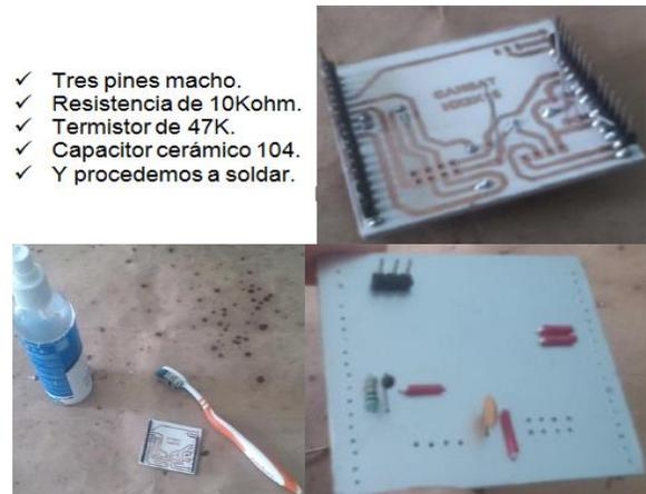
Figura 9 Limpieza y componentes de la placa
