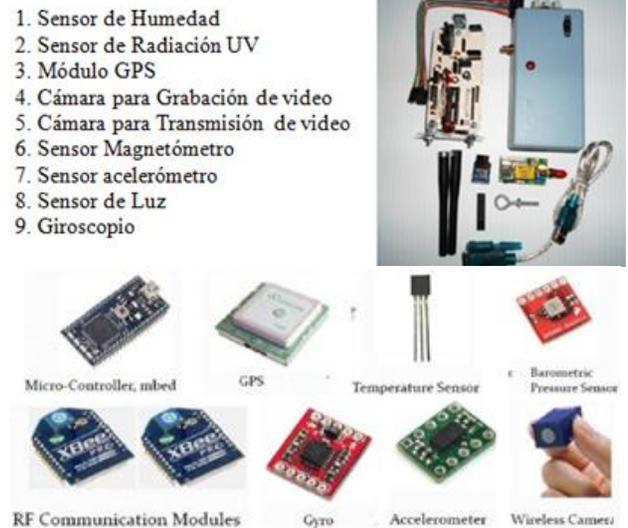
Figura 6 Sensores adicionales para el CanSat de telemetría
