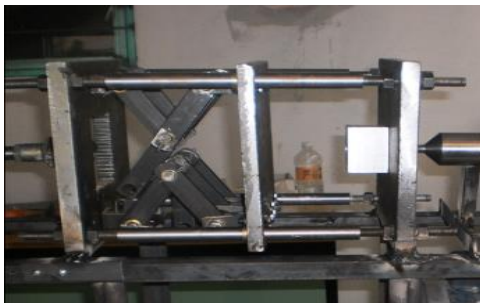
Figura 6 Vista frontal del mecanismo de apertura y cierre de molde
