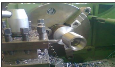
Figura 8 Maquinado del molde y segunda
