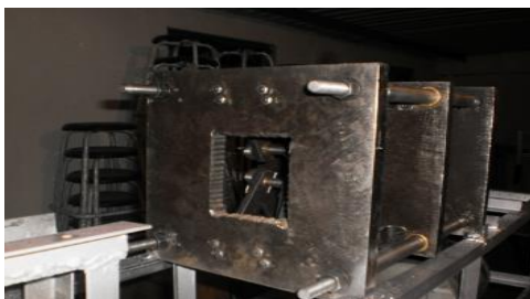
Figura 7 Vista lateral del mecanismo de apertura y cierre de molde
