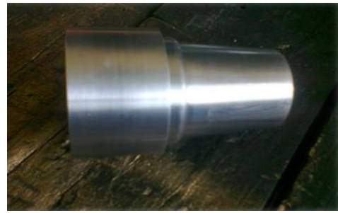
Figura 9 Vista lateral del molde (vaso)
