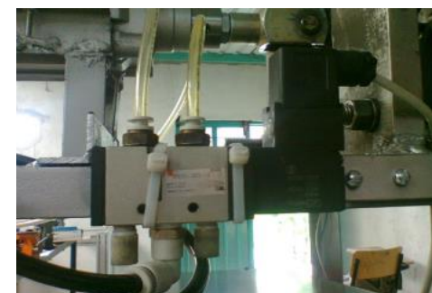
Figura 12 Conexión de la electroválvula
