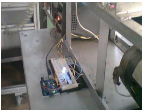
Figura 15 Pruebas de Arduino y los elementos de entrada y salida en un protoboard
