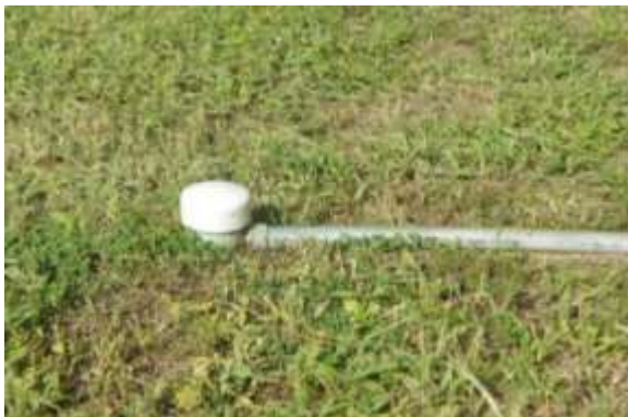
Figura 2 Sonda de medición instalada
