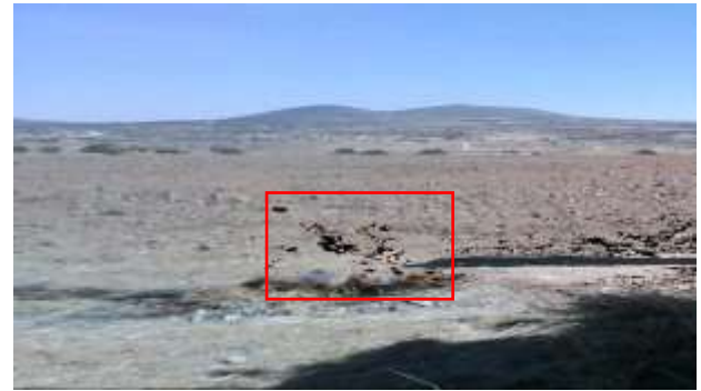
Figura 12 Identificación de fuego realizada por el algoritmo dos. Donde el recuadro rojo enmarca el área detectada
