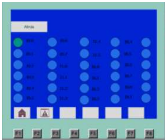
Figura 10 Pantalla de monitoreo de entradas del PLC en HMI
