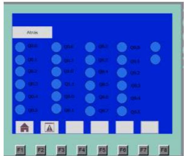
Figura 11 Pantalla de control de salidas del PLC en HMI
