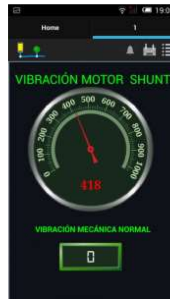
Figura 10 Vibración mecánica normal
