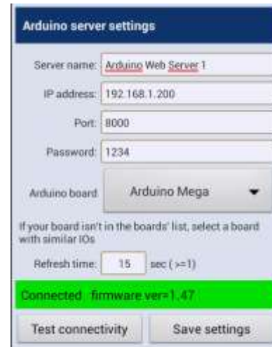
Figura 5 Dirección IP valida en virtuino
