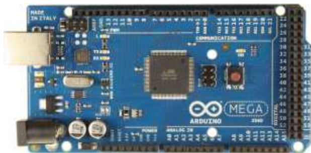
Figura 4 Arduino MEGA con microcontrolador ATmega2560
