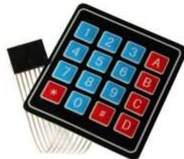
Figura 2 Teclado matricial tipo membrana de cuatro filas y cuatro columnas
