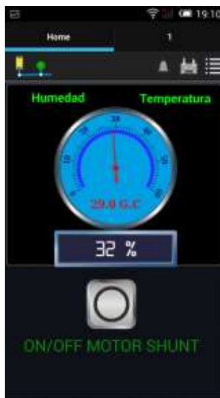
Figura 8 Temperatura/humedad y ON/OFF de motor
