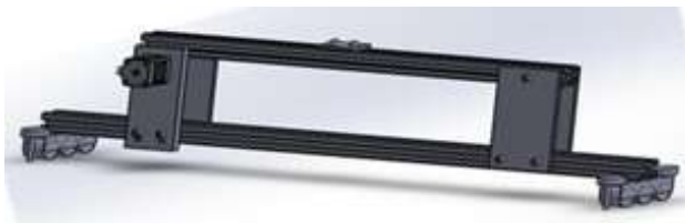
Figura 5 Ensamble del puente eje "Y"
