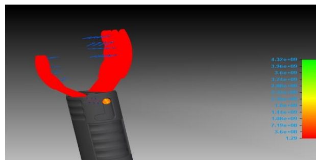
Figura 5 Factor de seguridad aplicando criterio de von Mises
