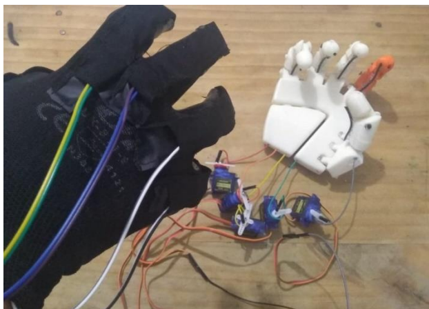
Figura 9a Control de movimiento de la prótesis subactuada
