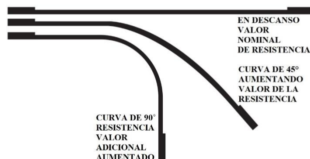
Figura 5 Lecturas de la resistencia variable según su curvatura
