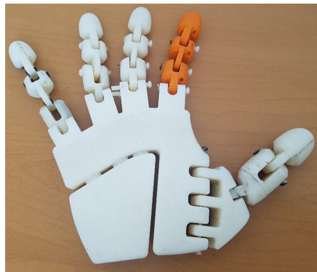
Figura 4 Manufactura aditiva de la prótesis de extremidad superior
