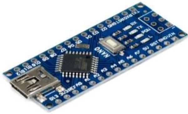
**Figura 8** Placa Arduino Nano
