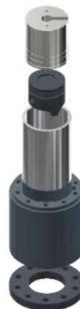
Figura 6 Despiece del ensamble virtual del dispositivo para pruebas de fatiga y compresión para pistones de motores a gasolina Fuente: Elaboración Propia
