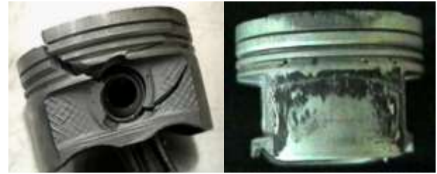
Figura 2 Daños en pistones por fatiga y por desgaste Fuente: Elaboración Propia
