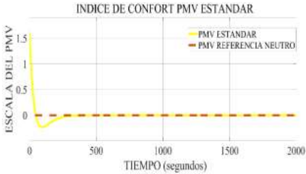
Gráfica 5 Escala de confort térmico obtenido por el modelo de PMV estándar Fuente: Elaboración Propia
