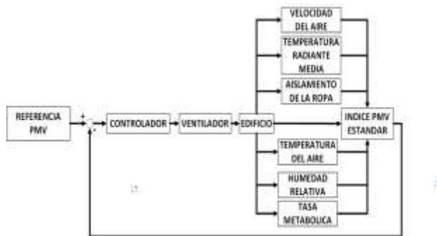
Figura 4 Diagrama de bloques representando el sistema con el índice de confort térmico estándar de seis variables.
