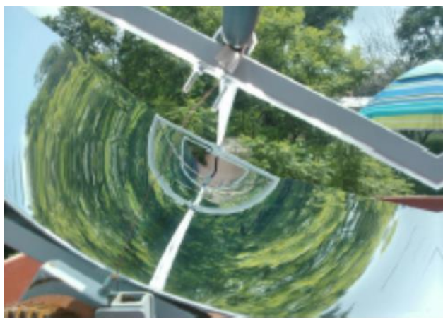
Figura 4 Fotografía del tubo receptor del CCP
