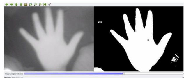
Figura 6 Asignación de umbral para escala de grises y segmentado con dicha información
