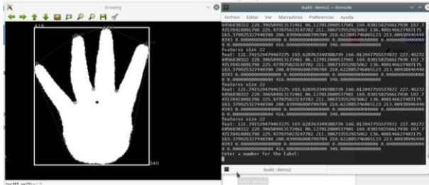
Figura 11 Identificación de mano con cuatro dedos extendidos y características extraídas
