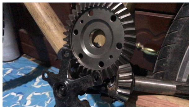
**Figura 9** Eje para acoplar la transmisión por engranes de la bicicleta de bambú
