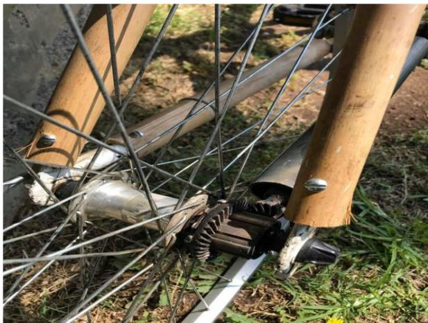
**Figura 7** Elementos traseros del cuadro de bicicleta con bambú
