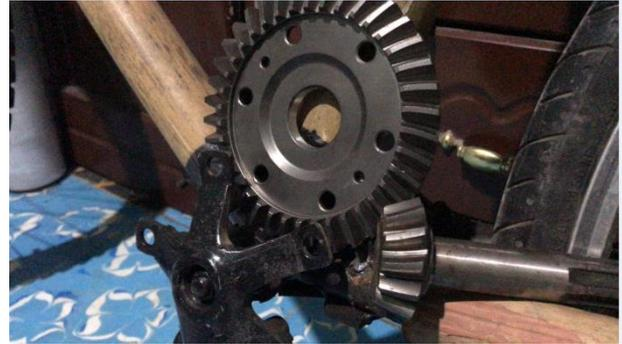
**Figura 9** Eje para acoplar la transmisión por engranes de la bicicleta de bambú
