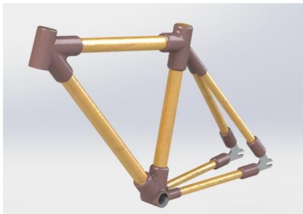
**Figura 1** Modelo renderizado (Solidworks) de la estructura de la bicicleta de bambú
