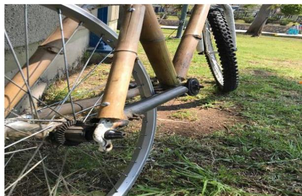
**Figura 6** Elementos delanteros del cuadro de bicicleta con bambú
