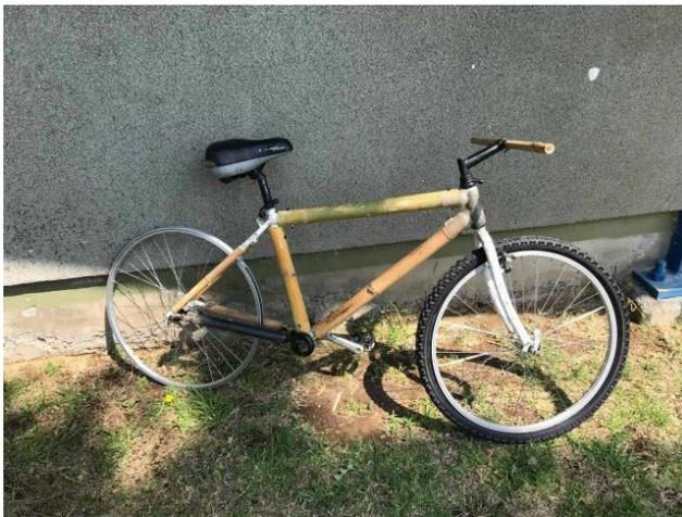
**Figura 8** Elementos traseros del cuadro de bicicleta con bambú
