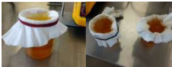
Figura 7 Filtración del RAUC Fuente: Elaboración propia
