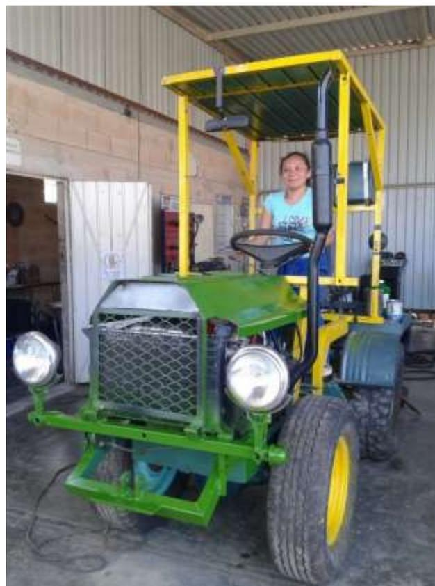
**Figura 6** Prototipo minitractor agrícola, vista frontal.
