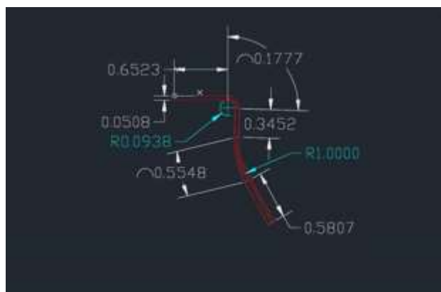
Figura 2 Dimensionamiento de pieza Contacto Auxiliar
