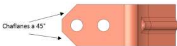
Figura 23 Chaflanes a 45° en pieza “contacto auxiliar”
