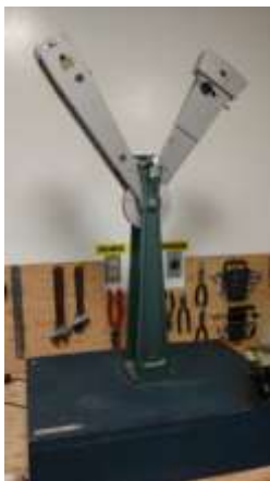
Figura 1 Máquina de impacto Monsanto tensómetro de doble brazo, modalidad Isod
