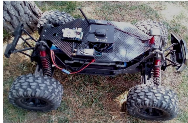
Figura 10 Vehículo rover instrumentado con el receptor Piksi RTK y la computadora Odroid
