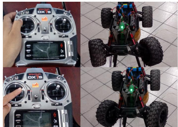
Figura 7 Pruebas de movimiento y asignación de canales en el vehículo
