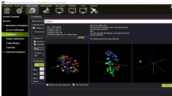
Figura 6 Interfaz Mission Planner; se aprecia la ventana de configuración del magnetómetro
