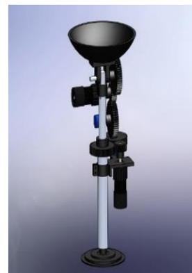
Figura 32: Diseño CAD del prototipo para el sistema de seguidor solar en SolidWorks.
