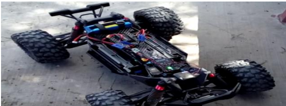
Figura 5 Rover instrumentado con Pixhawk y baterías de alimentación del mismo.
