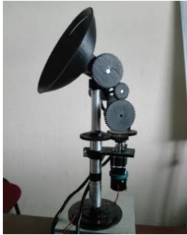
Figura 33: Prototipo real del sistema del seguidor solar.
