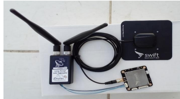
Figura 9 Receptor Piksi conectado a radio de telemetría
