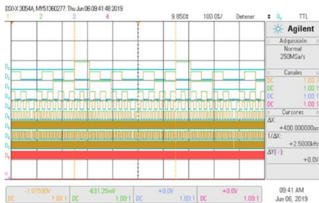
Figura 6 Lectura en el osciloscopio de la forma de onda triangular discretizada e implementada en el FPGA
