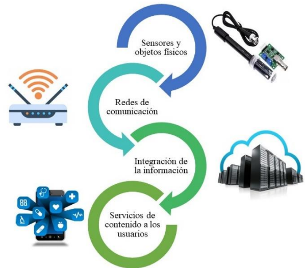
Figura 8 Arquitectura de IoT en 4 capas Fuente: Elaboración Propia
