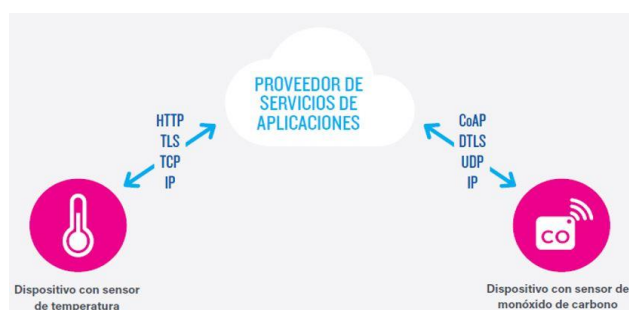
Figura 3 Ejemplo de la comunicación dispositivo a la nube Fuente: Karen Rose, 2015
