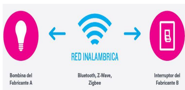
Figura 2 Comunicación dispositivo a dispositivo Fuente: Karen Rose, 2015
