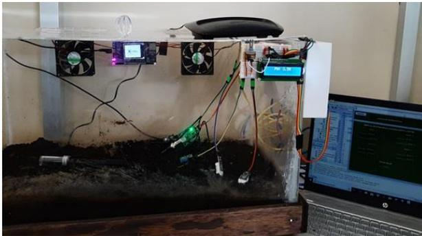
**Figura 9** Prototipo de lombricomposta con la implementación IoT
