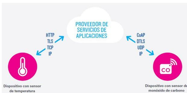
Figura 3 Ejemplo de la comunicación dispositivo a la nube
