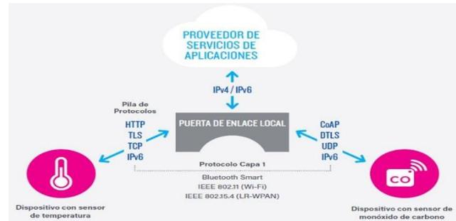
Figura 4 Comunicación dispositivo a puerta de enlace
