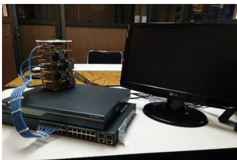
Figura 5 Conexión del clúster con el Router CISCO 1800 y Switch CISCO 2600
