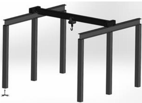
**Figurar 2** Modelo propuesto de grúa viajera y su estructura para uso industrial (fuente propia).
