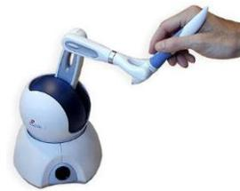
**Figura 2** Sistema háptico Phantom Omni de Sensable®.
