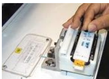
Figura 20 Tercer paso del método. Se coloca la plantilla con su guía sobre el conector a preformar
