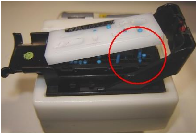
Figura 10 Vista B del primer diseño, dificultad para liberar la plantilla
