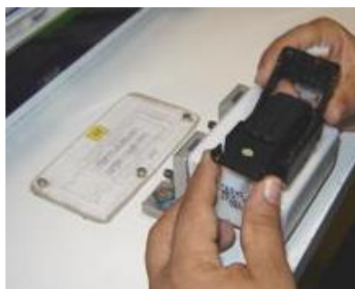
Figura 19 Segundo paso del método para utilizar la plantilla. Se coloca el conector en el sujetador
