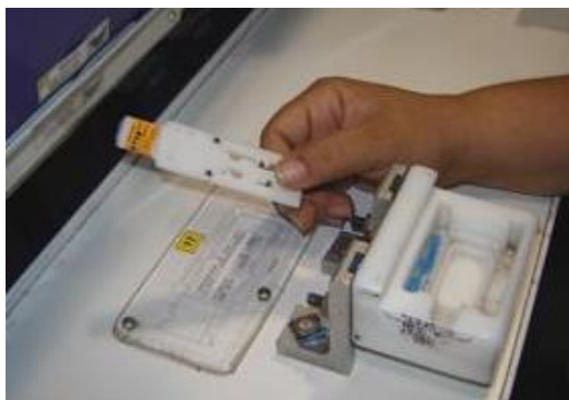
Figura 18 Primer paso del método para utilizar la plantilla. Toma la plantilla que corresponde al conector a preformar
