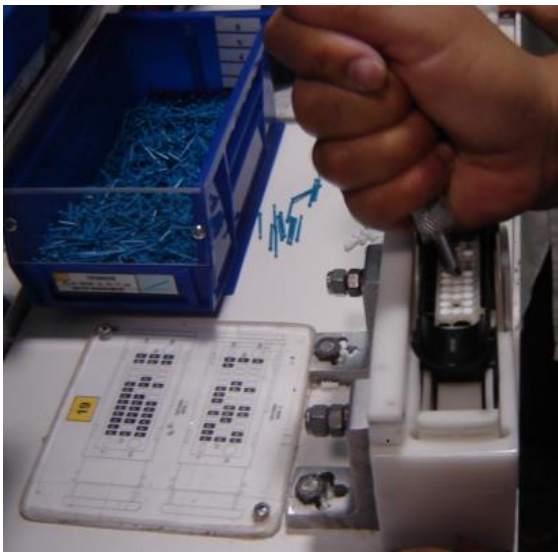
Figura 3 Uso de la herramienta para asegurar la inserción de las clavijas
