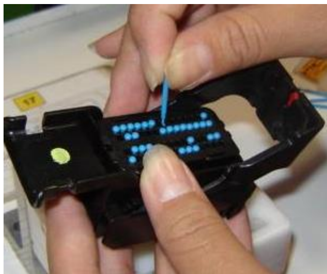
Figura 2 Inserción de las clavijas en el conector
