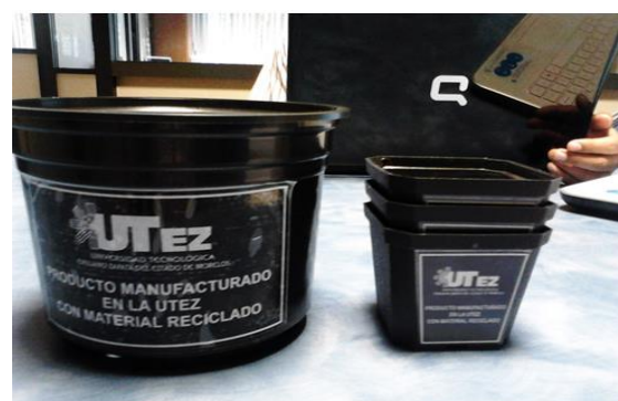
Figura 6 Macetas fabricadas con maquinaria propia dentro del campus de la UTEZ, con parte del material recopilado
