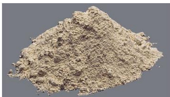
Figura 2 Mezcla homogénea de cemento y aceite automotriz usado
