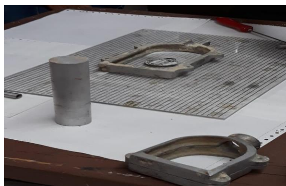
Figura 6 Pieza obtenida de la fundición
