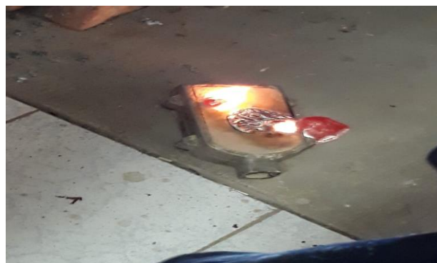
Figura 5 Vaciado en molde de arena
