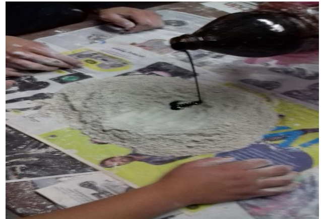
Figura 1 Elaboración de tierra para fundición
