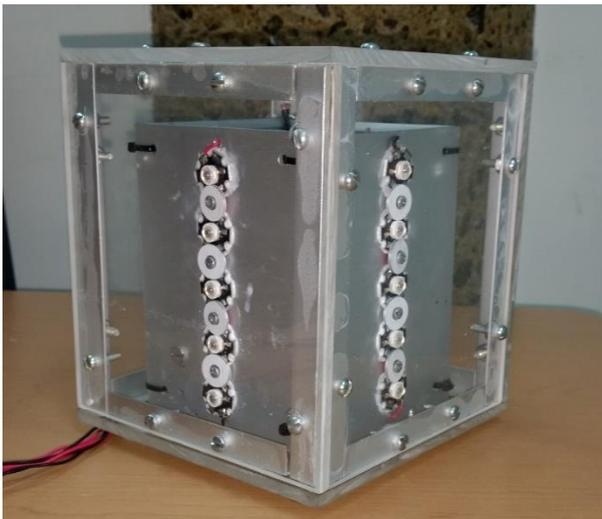
**Figura 6** Aspecto físico del prototipo final para una baliza del Sistema de Balizamiento de la Central Eoloeléctrica La Venta II
