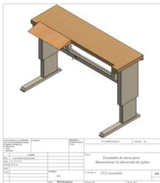
Figura 7. Ensamble de mesa para dimensionar la ubicación de ojales
