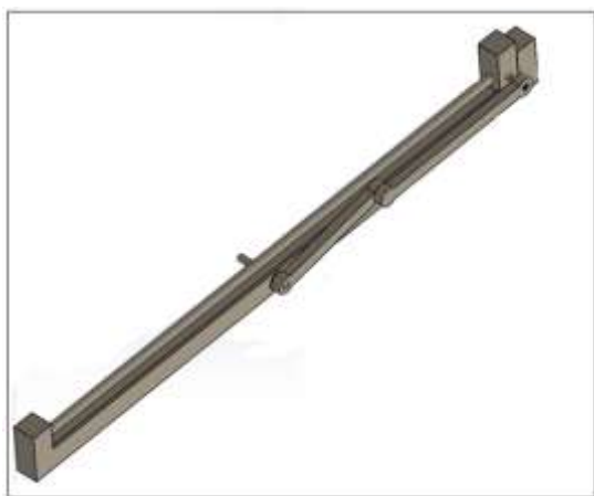
Figura 5 Mecanismo manivela-biela corredera. (Elaboración Propia)
