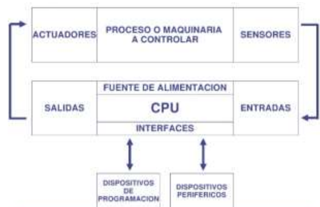
Figura 1 Arquitectura del PLC
