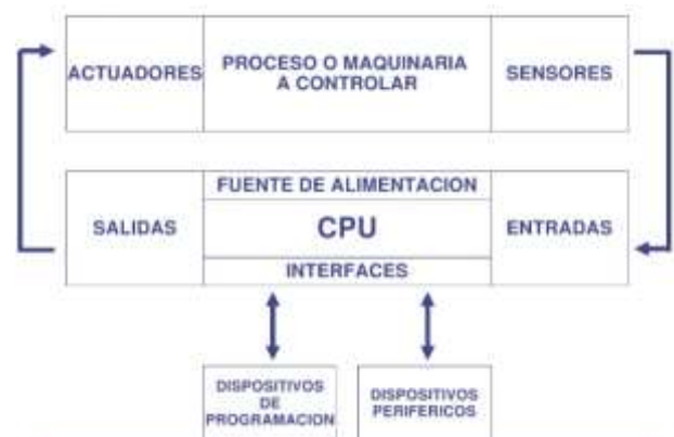
Figura 1 Arquitectura del PLC
