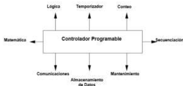
Figura 2 Funciones principales del PLC
