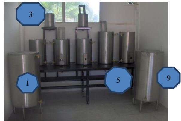
Figura 10 Planta Piloto; 1 = Tanque de almacenamiento para aceite usado; 2 = Reactor de prelavado; 3 = Deposito de ácido sulfúrico; 4 = Reactor de esterificación; 5 = Deposito de metóxido; 6 = Reactor de transesterificación; 7 = Reactor de lavado; 8 = Reactor de secado; 9 = Tanque de almacenamiento para biodiesel. (Fuente Autores)
