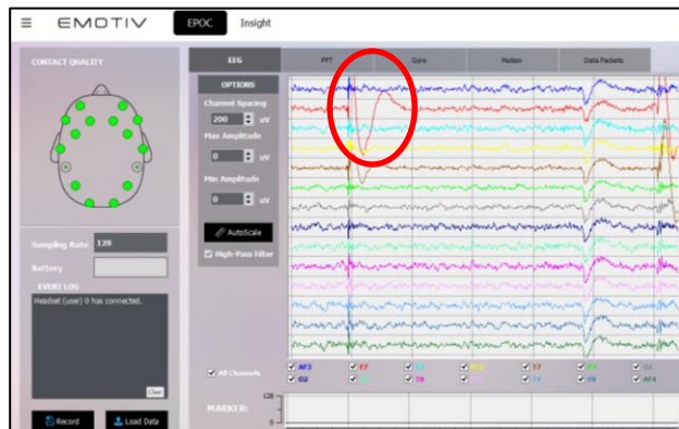
Figura 14 Muestra de electroencefalograma con evidencia de movimiento de la boca a la derecha en sujeto de prueba #6.
