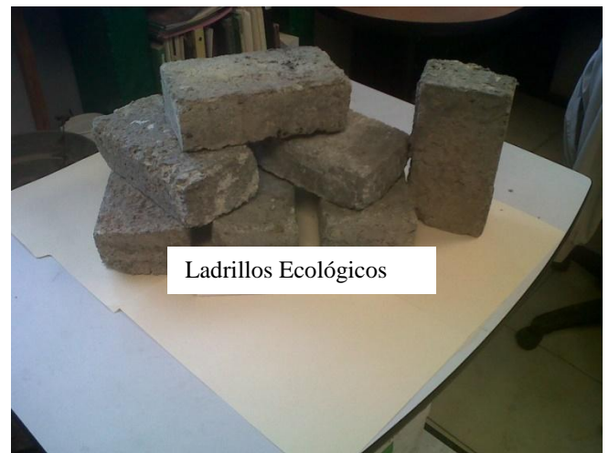
Figura 2 Imagen de Ladrillos Obtenidos a partir de material de desecho (papel y aserrín).
