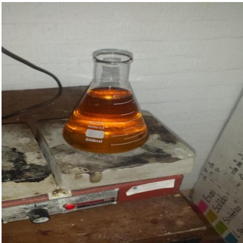
Figura 4 Eliminación de presencia de agua.
